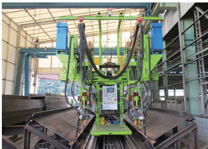
自社開発のガルウイング自動溶接装置
