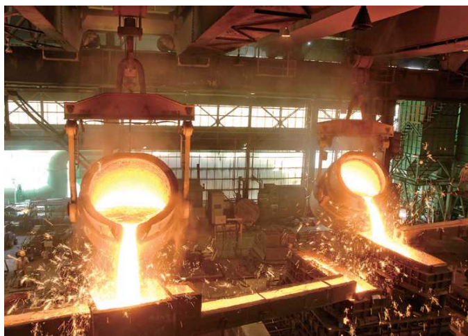
溶けた鉄を型に流し込む「鑄込み作業」 その迫力に圧倒されます
